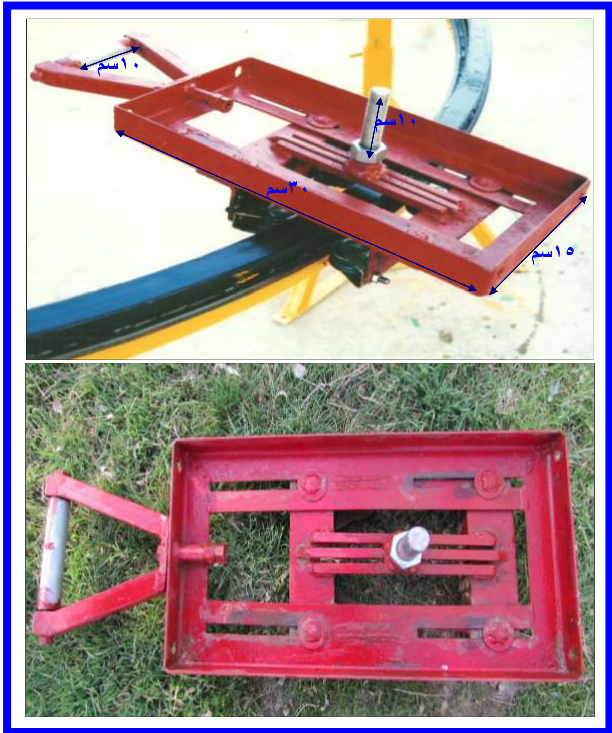
الشكل (٤) يوضح القاعدة المثبتة على الجهاز المقترح
